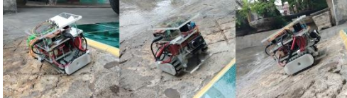
Gambar 3.9 Uji Coba pada Area Menanjak atau Menurun
