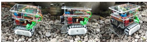
Gambar 3.10 Uji Coba pada Area Terjal atau Berkerikil
