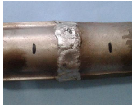
Gambar 4.1. Hasil Pengelasan Pipa Aluminium 5052
