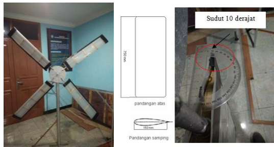
Gambar 5. Model Blade Profil NACA 0015 Dan Sudut Blade
